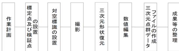
図R-T.3-3 UAVを用いた空中写真による3次元点群測量における工程別作業区分及び順序 1)
