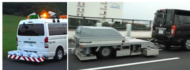
写真R-T.7-3 路面下探査車
