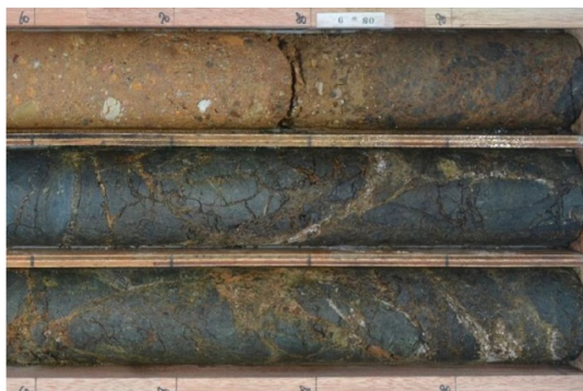
写真5.3-1 ボーリングコアの洗浄前後の違い 3) マッドケーキを洗い流さないと正確なコア判定は困難である
