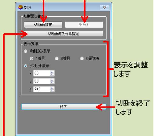
あらかじめ作成してある切断面ファイルの座標で切断します
