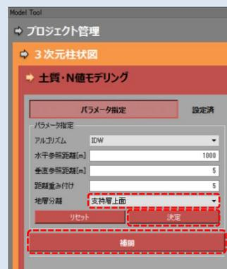
支持層の上下や地層でモデルを分離する場合※は、支持層モデルおよび地層モデル作成後、「土質・N値モデリング」の「地層分離」より「支持層上面」が「地層」を選択し、「決定」ボタンを押して「補間」ボタンを押してください
